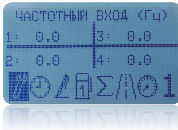
Рисунок 44 – Частотные входы ETS.BUK
